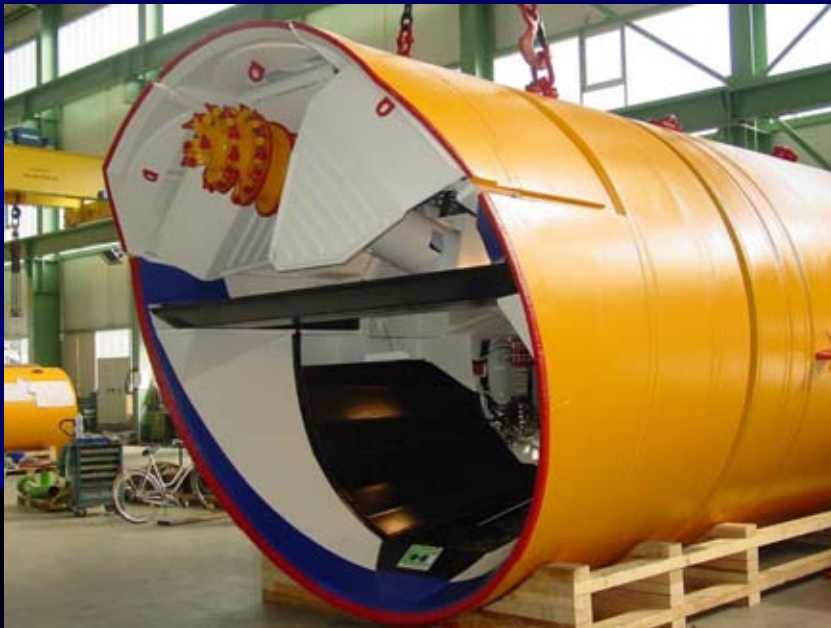
TBS za tunel ispod kolodvora u Grazu
